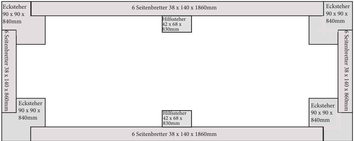
3. Bohren Sie auf beiden Seiten des Hochbeets ein Loch im unteren Drittel der Höhe der 42 x 68 Hilfssteher. Bringen Sie nun die Gewindestange in dieses Loch ein und fixieren diese auf beiden Seiten mit den beigegeführten Schrauben und Beilagen.
